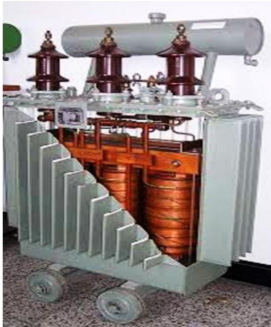
شکل 1-نمای یک ترانسفورماتور قدرت
